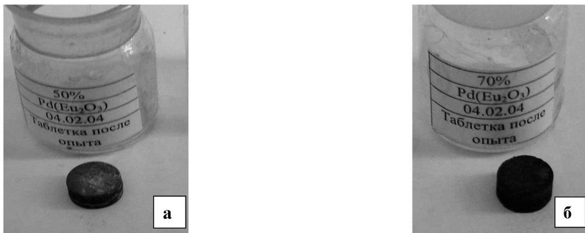
Рис. 5. Внешний вид таблеток с содержанием оксида европия 50% (а) и 70% (б)
