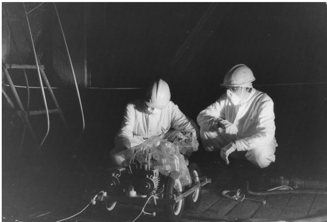
Дистанционно-управляемый детектор для оценки количества ядерного топлива в помещениях объекта «Укрытие».
