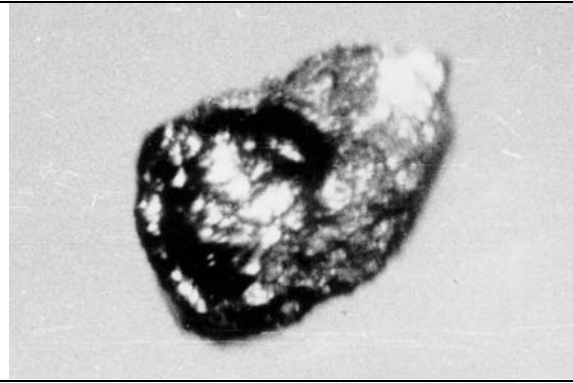
Рис. 4. Частица уран-циркониевого состава с оплавленной поверхностью. Увеличение 100 (оптический микроскоп).
