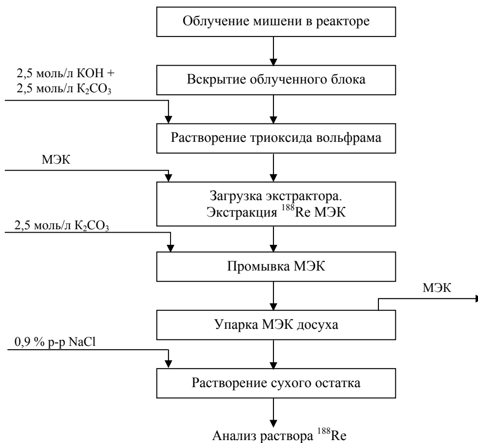
Рис. 2. Принципиальная схема установки по производству РФП на основе ^{188}\text{Re}
