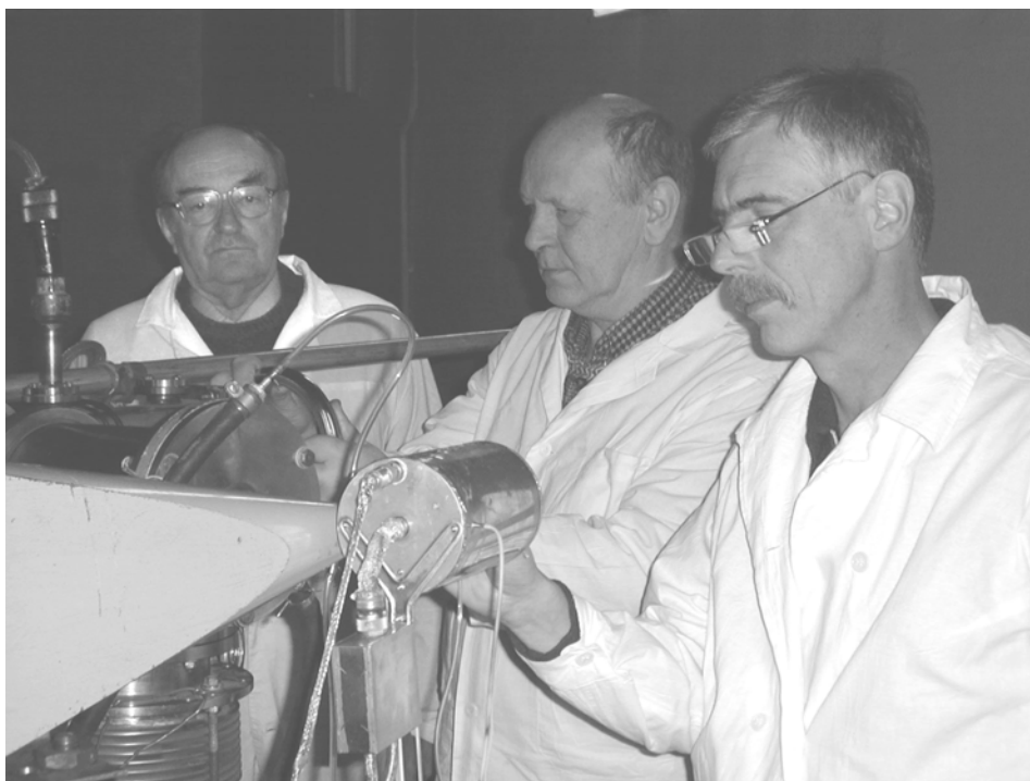
Рис. 6. Подготовка установки для прецизионных измерений спектров мгновенных нейтронов ^{241}\text{Am} на нейтронном генераторе НГ-400.
