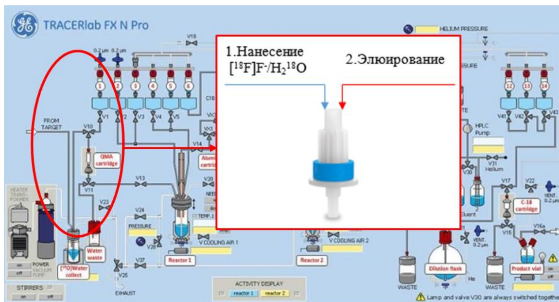
Рисунок 14 - Блок выделения фтора-18 из облученной воды в модуле TRACERlab FX N Pro.
