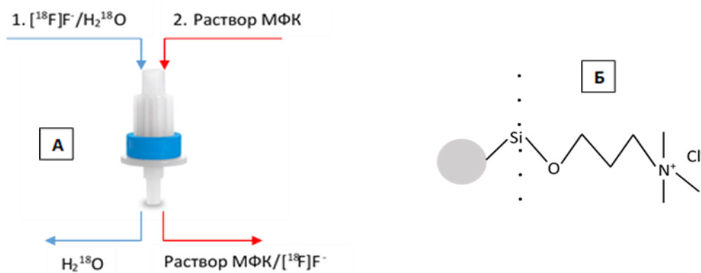
Рисунок 9 - А: схема выделения фтора-18 на анионообменном картридже Sep-Pak Accell Plus QMA Plus Light Cartridge; Б: структурная формула анионообменного сорбента.
