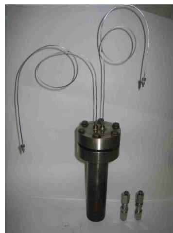
Рисунок 4 - Внешний вид барботёров и ячеек. Слева - барботер, справа – ячейки
